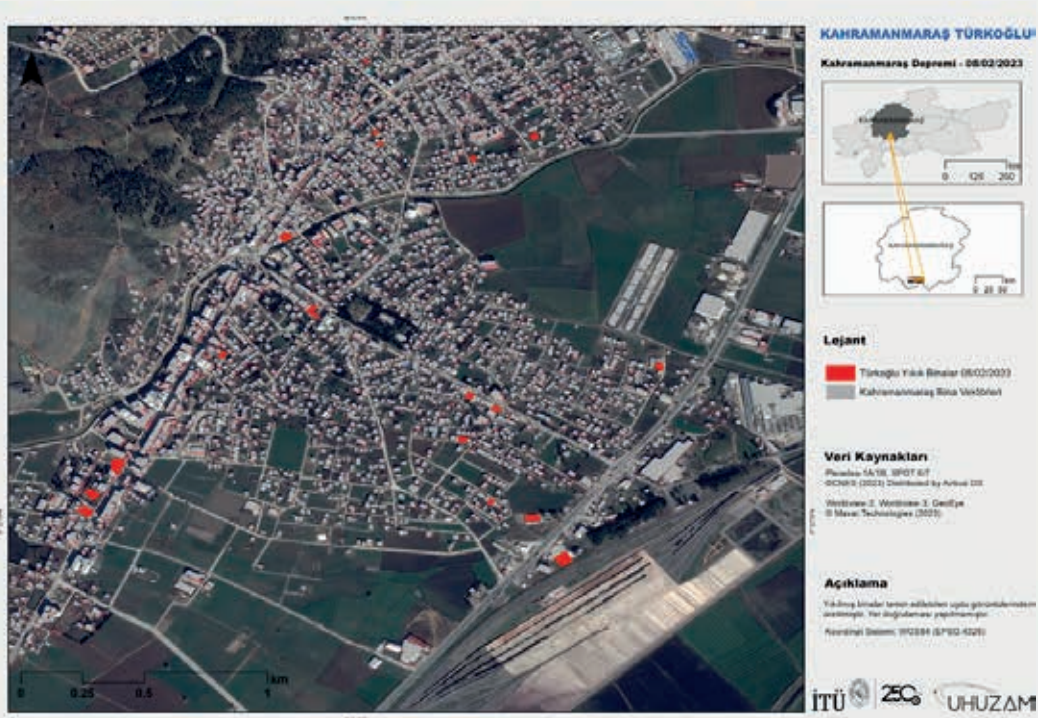
Şekil 3.14. Uydu görüntülerinden tespit edilen Kahramanmaraş-Türkoğlu'ndaki yıkık binalar
