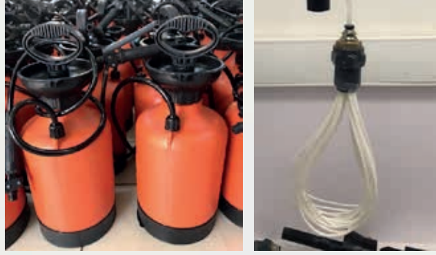
Şekil 5.1.5. El gücü ile çalışan membran sistemi (sol), sistem içerisindeki ultrafiltrasyon modülü (sağ)
