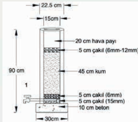
Şekil 5.1.4. Ev tipi kum filtresine ait kesit görüntüsü (Mahmood ve diğ., 2011)
